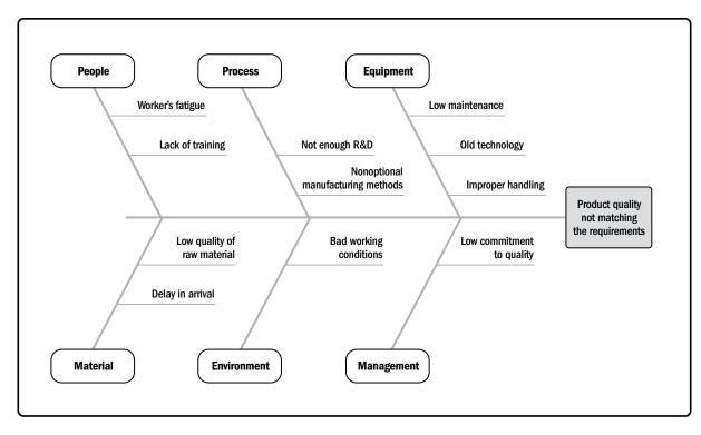
Figure 8-9. Cause-and-Effect Diagram
